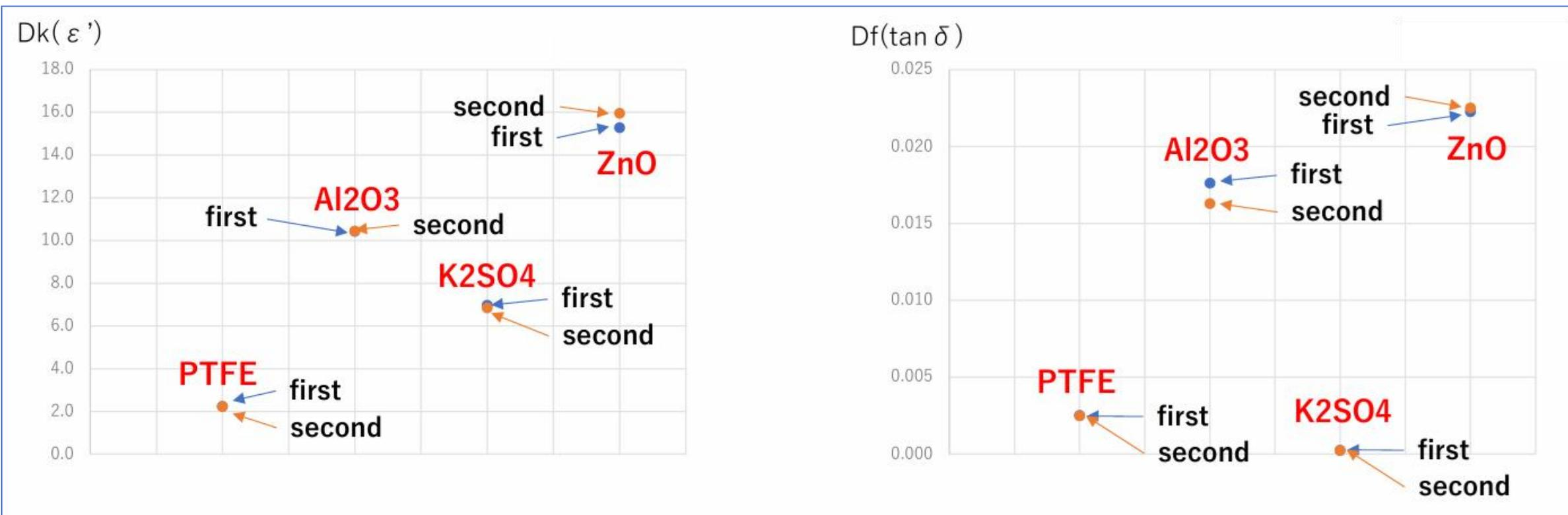
北京某研究所测量四种粉末材料在10 GHz的的Dk和Df值
